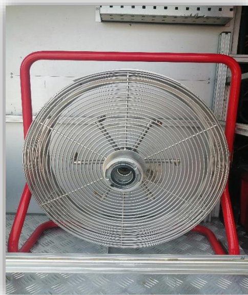
46. Generator piany lekkiej – OSP Szmurły
